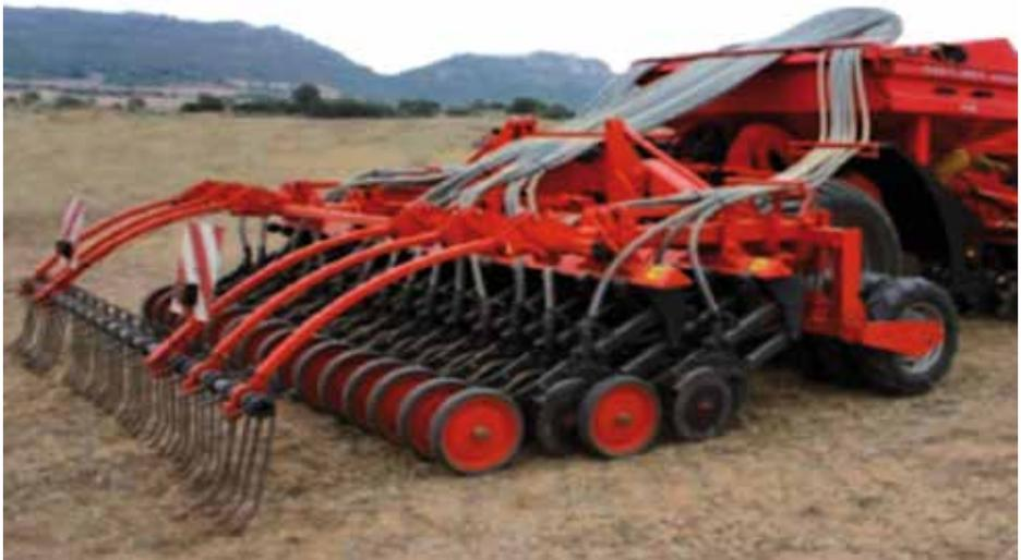
Fig. 5.9 Semina e localizzazione del fertilizzante
